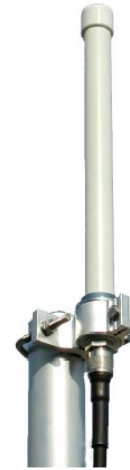
شكل 2: هوائي متعدد الإتجاهات Omni-directional ذو ربح قدره 6 ديسيبل ونمط الإشعاع الموافق
