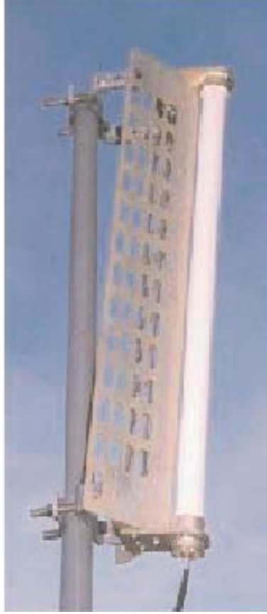
شكل 5: هوائي قطاعي (Sectoral Antenna (A2.45LP14 180
